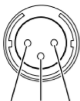
Pin 1 Pin 3 Pin 2 Symmetrischer Ausgangsanschluss (für XLR-Stecker)
