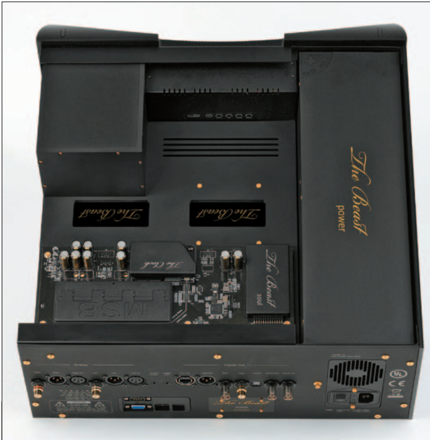
EDLER BAUKASTEN: Jedes unterschiedliche Segment der Klangaufbereitung wurde in ein eigenes Subgehäuse gefasst. Der (unhörbare) Ventilator fechtelt dem Netzteil Luft zu.
