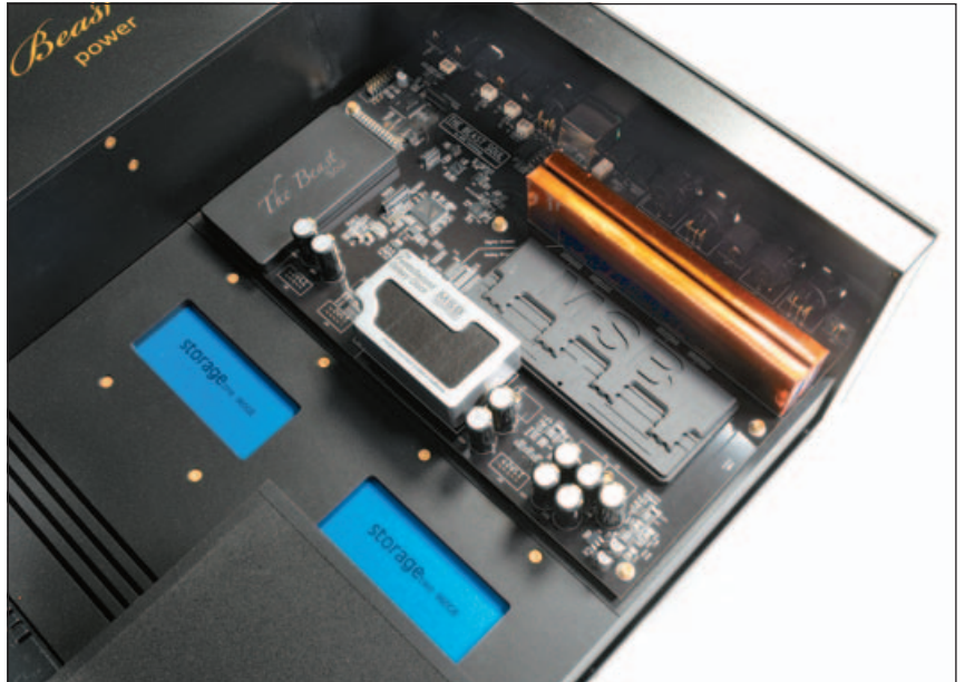
ZUGABE: Wer schlau ist, ordert The Beast mit einer aktiven Lautstärkeregelung (plus 3000 Euro) – verbaut in den beiden kupferfarbenen Modulen oben hinter der Master-Clock.
