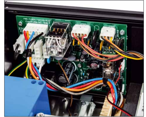
Ohne steuernde Elektronik geht's nicht: Diese Platine steckt in der Pneumatik-Steereinheit
